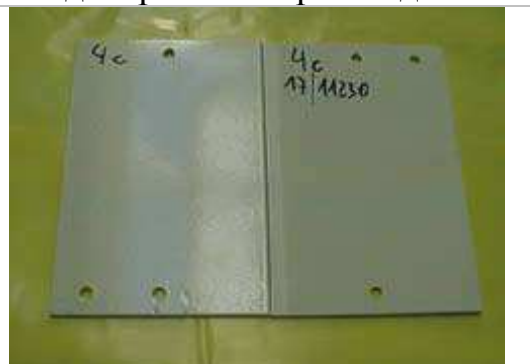
*Точковидни дупчици в следствие на некачествено обработена стомана
