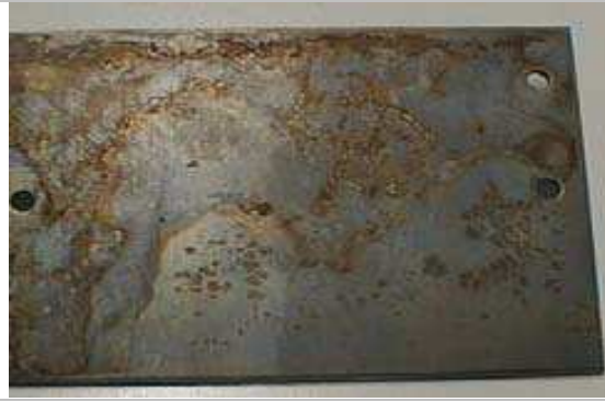
*Некачествено обработена повърхност, вследствие на което остава мокра
