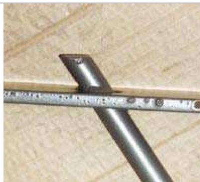
*Балончета образувани вследствие на първичната обработка
