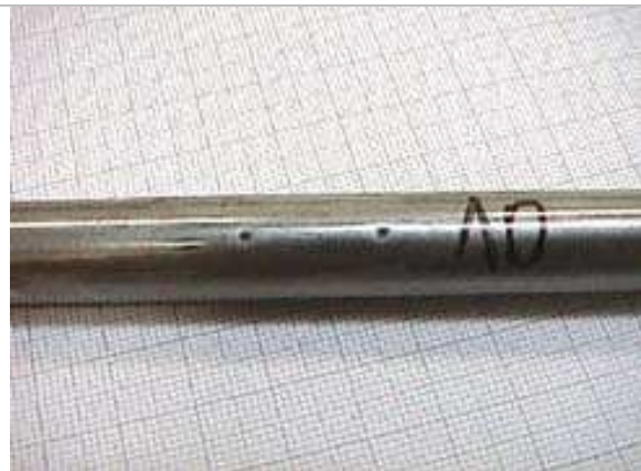
*Образуване на кратери в резултат на наличието на масла в компресирания въздух
