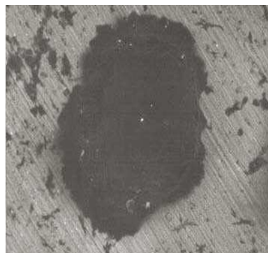
*Остатъци върху алуминия след първичната обработка
